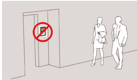
Negativbeispiel: Unzulässige Platzierung einer Zimmersignalleuchte in einer schlecht einsehbaren Nische
