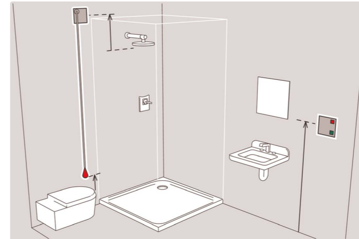
Platzierung von Zugtastern in Nasszellen
